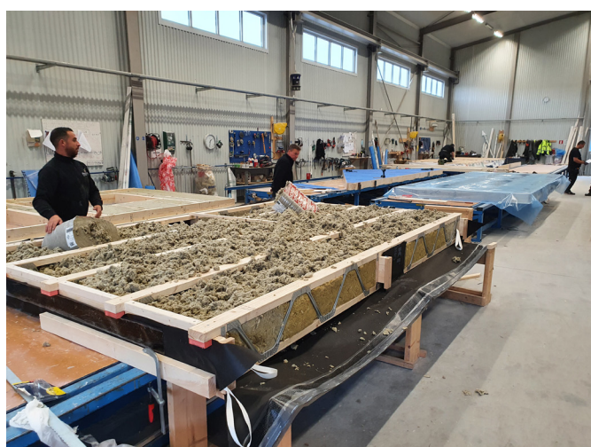
Skivisolering inne i Posi-Joisten och kassetten fylls med lösull redan i fabrik.
