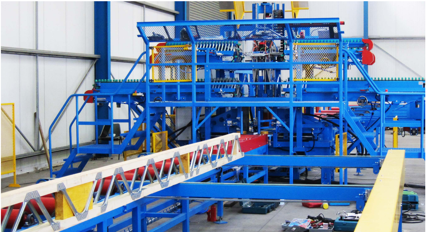
Posi-tillverkning i fabrik.
