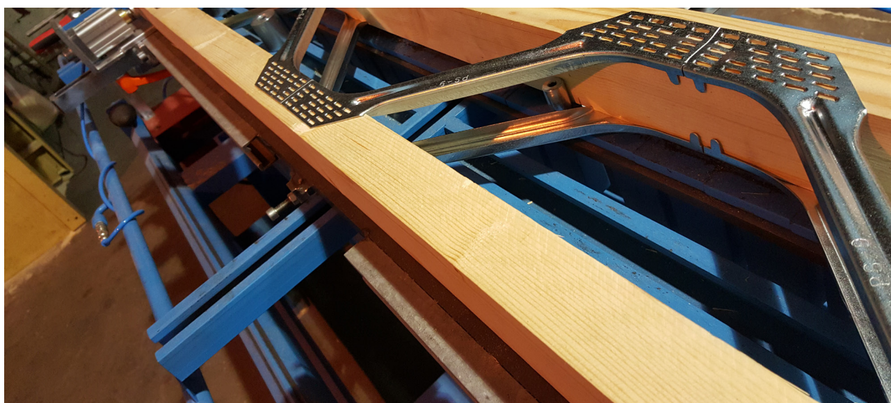
Posi-Joist-bjälklag kombinerat med ett traditionellt ramverk.
